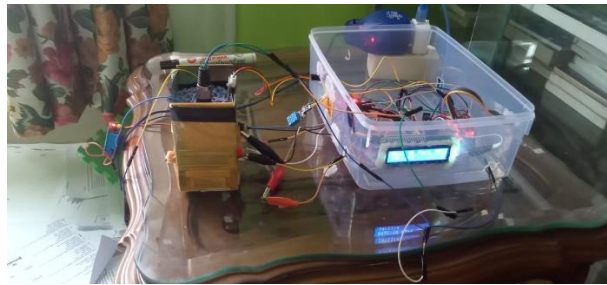
Gambar 5. Prototipe Sistem Data Logger Alat Ukur Ec Berbasis Arduino UNO Mikrokontroler ATmega328
