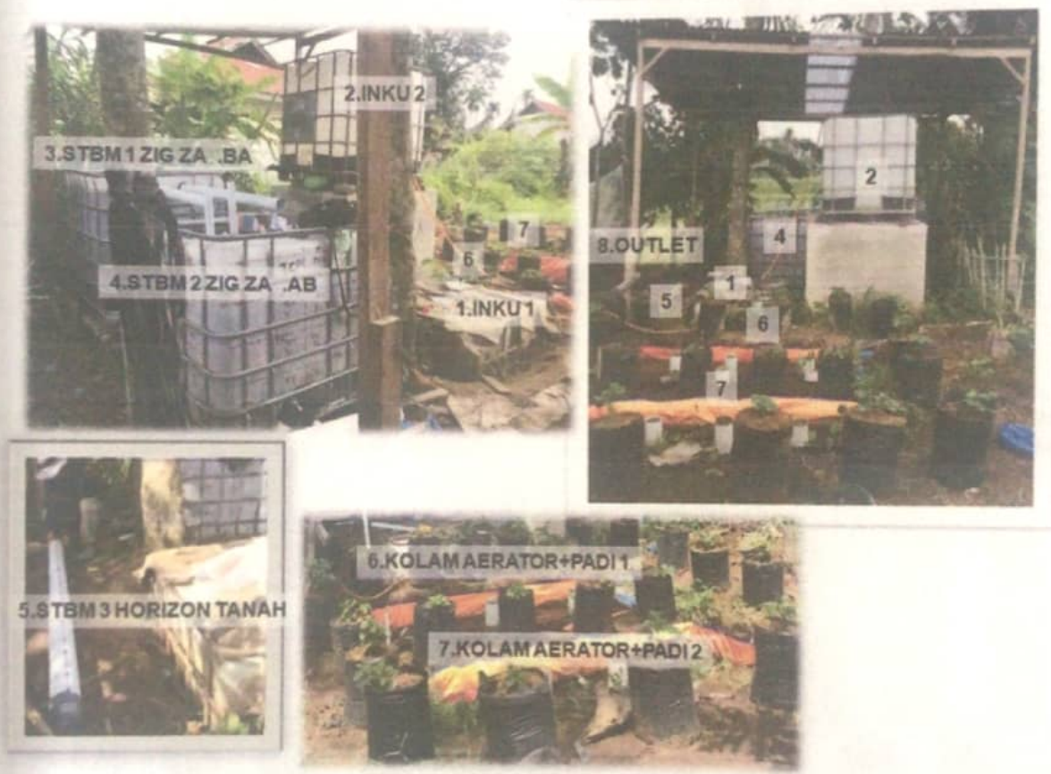
Jambaran 1. Inovasi Cerdas STBM tipe Zigzag aliran bawah atas dan atas bawah dan tipe horizon tanah memurnikan Air minum PDAM di uji coba dilapangan di Kampus Politani Payakumbuh
