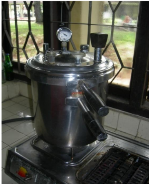
Gambar 13. Autoclaf yang digunakan untuk mensterilkan alat-alat dalam proses membuat yogurt
