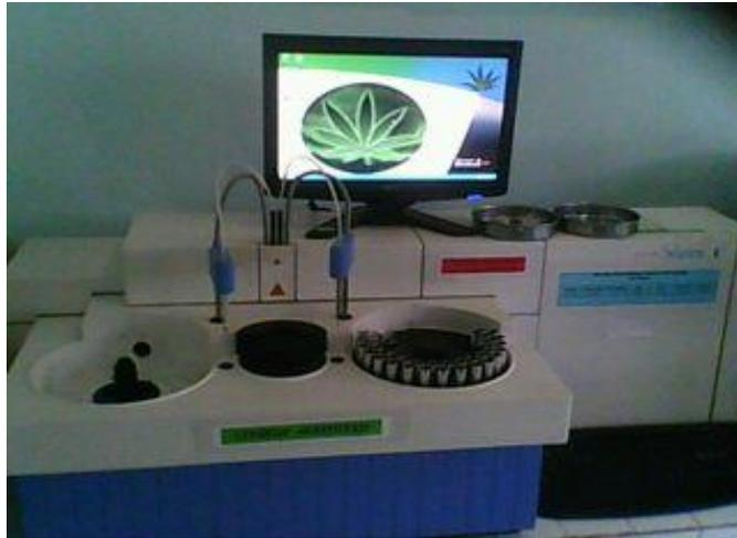
Gambar 15. Alat *Selectra E Autoanalyzer*, untuk menguji kadar kolesterol tikus dengan metode WI-M-KK 2 BLK-SB (*Clinical Chemistry Autoanalyzer*) di UPTD. Laboratorium Kesehatan Propinsi Sumatera Barat.
