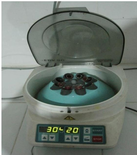
Gambar 12. Sentrifuge dengan kecepatan maksimum 4000 rpm
