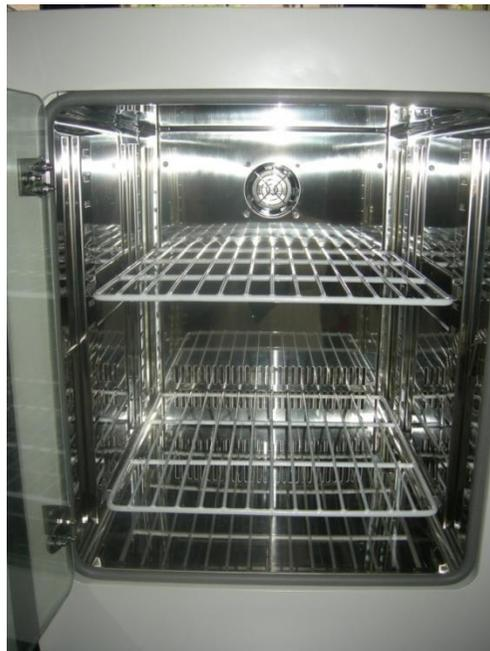
Gambar 14. Inkubator yang digunakan untuk penyimpanan selama proses fermentasi selama 12 jam dengan suhu 33 derajat celsius.
