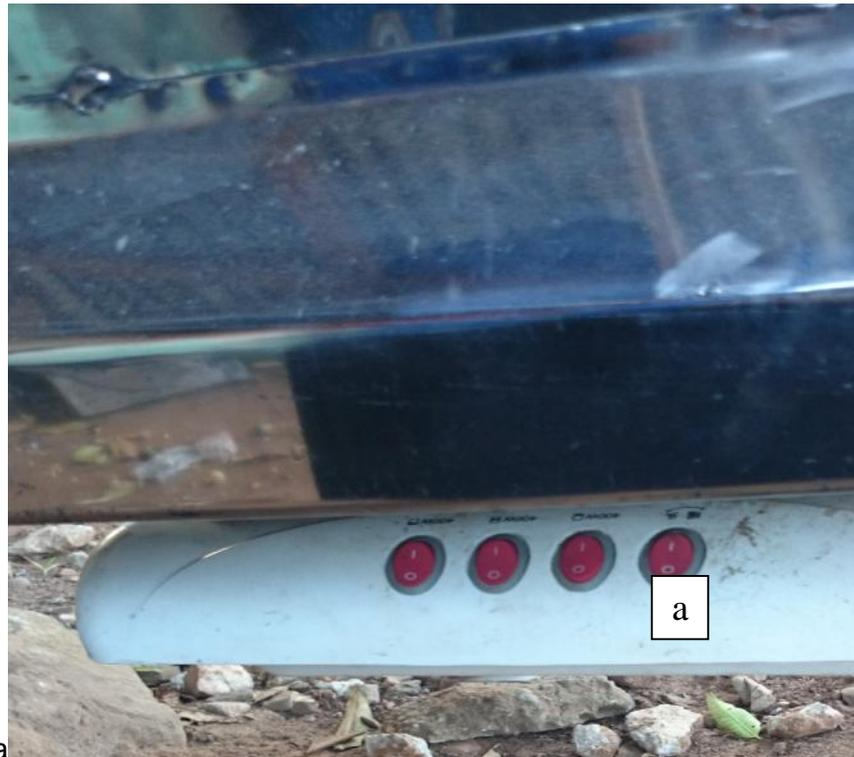
Gambar 1. Pengatur sirkulasi udara pada oven pengering
