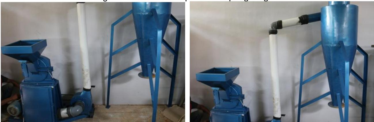
Gambar 2. Mesin pengiling kulit manggis dengan penambahan siklon untuk mengurangi losses
