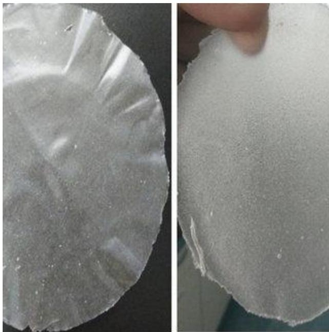
Gambar 21. Hasil casting bioplastik
