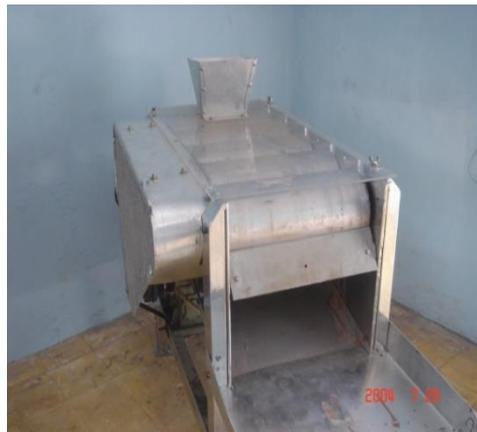
Gambar 29. Alat pemasta halus (refiner)
