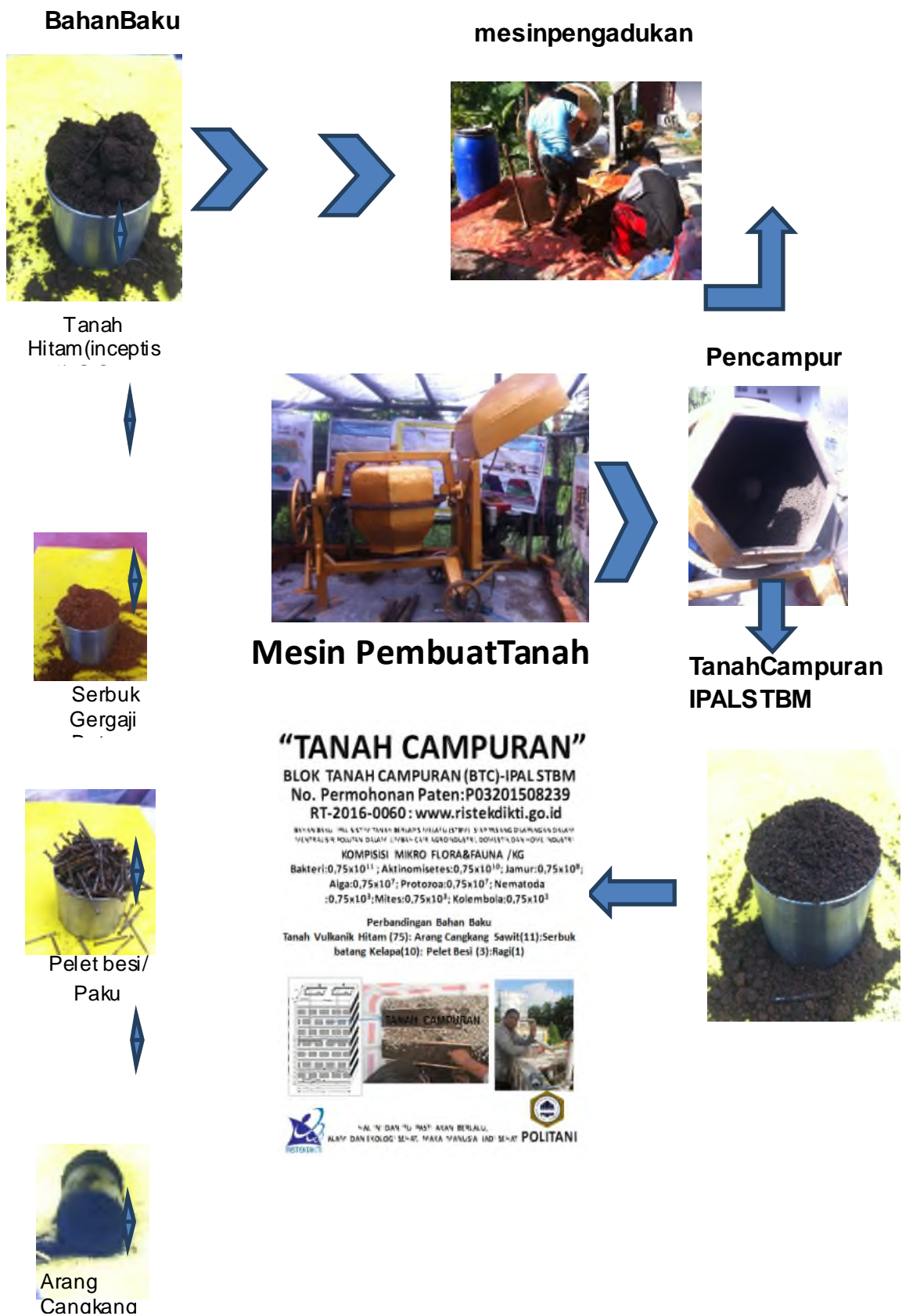
Gambar 25. Proses produksi Tanah Campuran secara mekanis di Pabrik Mini
