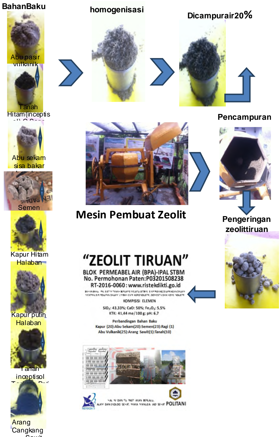
Gambar 26. Proses produksi Zeolit Tiruan secara mekanis di Pabrik Mini
