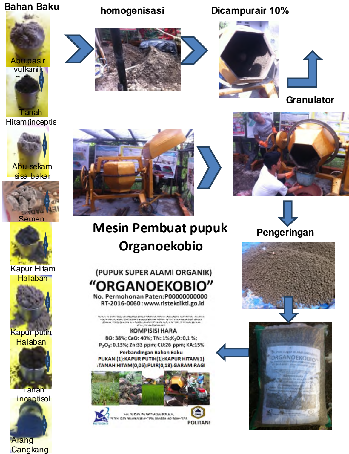
Gambar 29. Proses produksi Pupuk Organoekobio secara mekanis di Pabrik Mini
