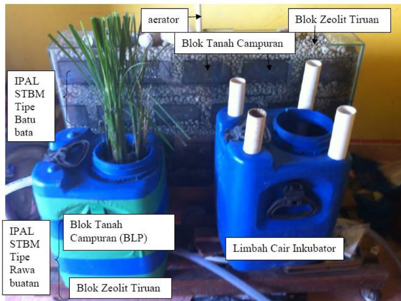
Gambar 19. Rekayasa IPAL STBM Berjalan untuk Pendidikan bagi home industri kapasitas mengolah Limbah cair 200-800 L/hari
