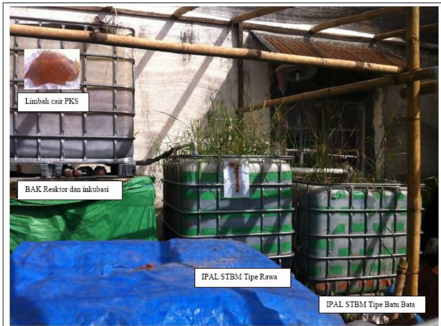
Gambar 20. Rekayasa IPAL STBM Lapangan untuk mengolah Limbah cair industri PKS kapasitas mengolah Limbah cair 1500-6000 L/hari
