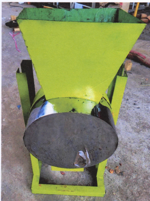
Gambar 1. Foto Mesin Pengiris Pinang Muda Prototipe Politani dari Posisi Pemasukan
