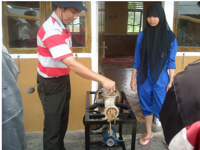
Gambar 1 Pencetakan suplemen dengan mesin pelet
