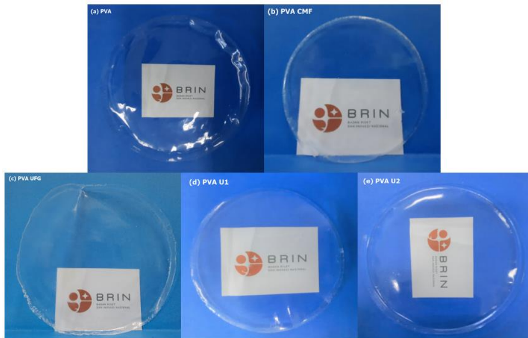
Gambar 7. Produk sampel Biokomposit (a) PVA. (b) PVA CMF, (c) PVA UFG, (d) PVA U1, dan (e) PVA U2.
