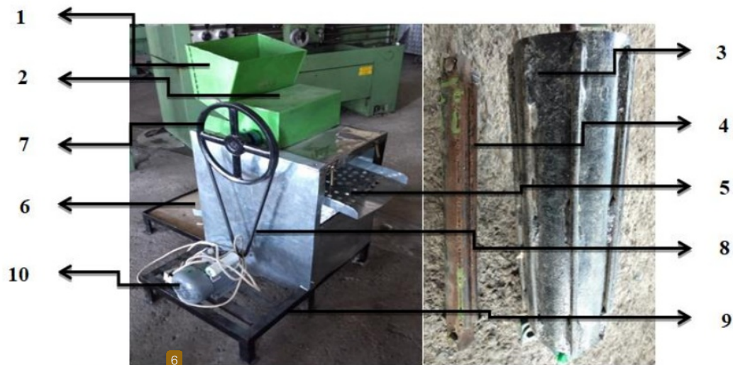
Gambar 11. Mesin pengupas kulit kacang tanah dengan tipe silinder horizontal
