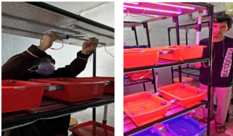
Gambar 11. Proses Aplikasi Peralatan Lampu UV pada Rak Hidroponik DWC, Pengujian Perangkat dan Pengecekan Akhir Perangkat Pencahayaan Keseluruhan
