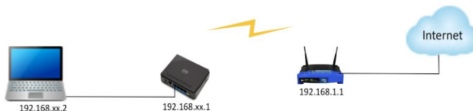
Gambar 1.29. Simulasi Jaringan Dasar Mikrotik Untuk Koneksi ke Internet
